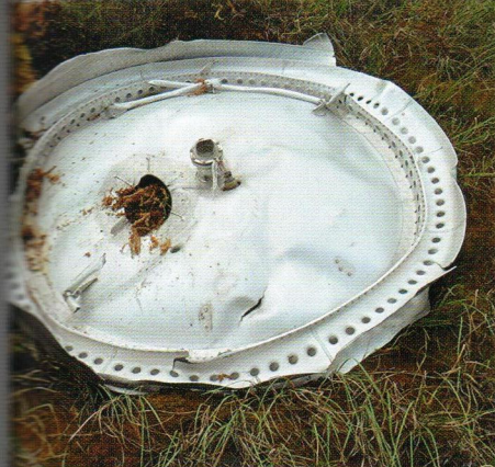
▲ Фрагмент днища бака окислителя центрального блока РН «Союз-2.1А», обнаруженный в районе падения №368
